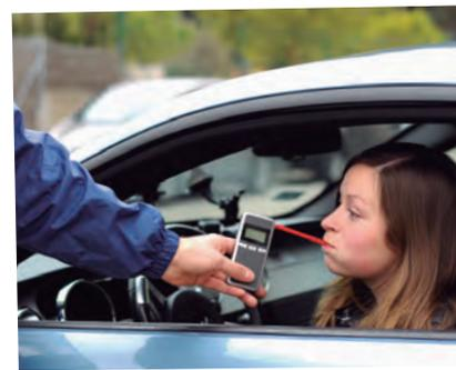
El alcotest es un instrumento que permite detectar niveles de alcohol en la sangre a través del aliento.
